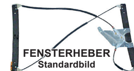
22 91 220 Fensterheber vorne re. 22 91 221 Fensterheber vorne li. ohne Motor; elektr. Ausführung
