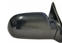
64 12 124 Spiegel re. 64 12 125 Spiegel li. beide elektr. verstellbar; 3/4-türig
