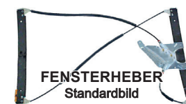
74 31 120 Fensterheber vorne re. 74 31 121 Fensterheber vorne li. ohne Motor; elektr. Ausführung 74 31 122 Fensterheber hinten re. 74 31 123 Fensterheber hinten li. ohne Motor; elektr. Ausführung
