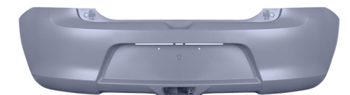
64 16 055 Stoßfänger hinten grundiert ohne PDC
