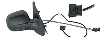
Kleines Gehäuse 74 24 024 Spiegel re. konvex Temp.Sensor 74 24 124 Spiegel re. konvex beide manuell/Kabel verstellbar
