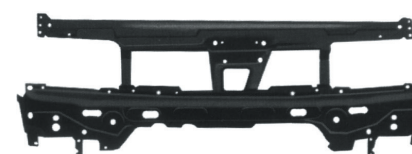
74 22 002 Frontmaske für Kühler 430x322mm nicht für Klimafahrzeuge
